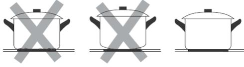
تأكد من أن قاعدة المقلاة ناعمة ، وتجلس بشكل مسطح على الزجاج ، وبنفس حجم منطقة الطهي. استخدم المقالي التي يكون قطرها كبيرا مثل رسم المنطقة المحددة. باستخدام وعاء ، سيتم استخدام طاقة أوسع قليلا بأقصى قدر من الكفاءة. إذا كنت تستخدم وعاء أصغر ، فقد تكون الكفاءة أقل من المتوقع. ضع المقلاة دائما في منطقة الطهي.
