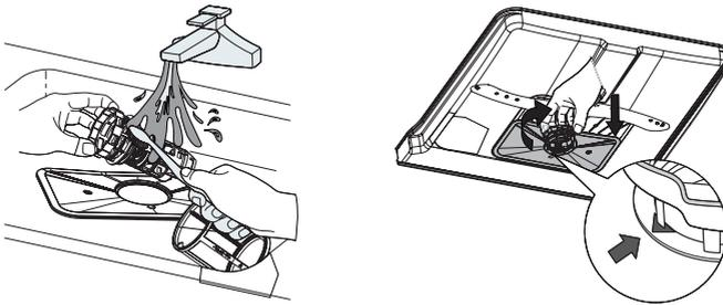
5. Соберите фильтры в порядке, обратном разборке, замените вставку фильтра и поверните по часовой стрелке до стрелки закрытия.
