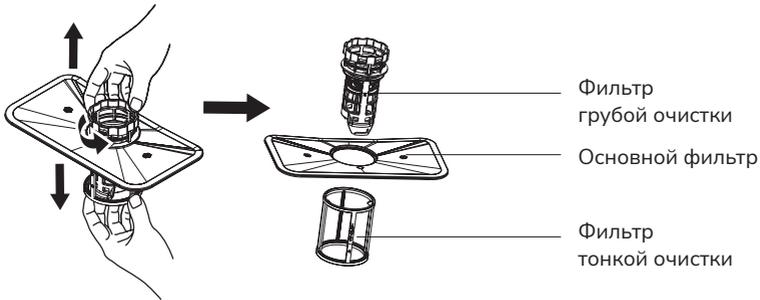
4. Более крупные остатки пищи можно удалить, промыв фильтр под проточной водой. Для более тщательной очистки используйте мягкую чистящую щетку.
