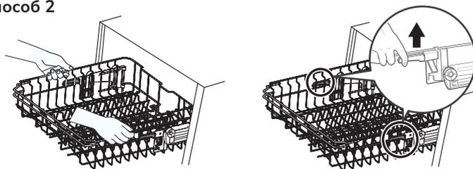
Чтобы поднять верхнюю корзину, возьмитесь за нее по центру с каждой стороны, пока корзина не зафиксируется в верхнем положении. Нет необходимости поднимать ручку регулировки. Чтобы опустить корзину, поднимите регулировочные ручки с каждой стороны, чтобы освободить корзину и опустить ее в нижнее положение.
